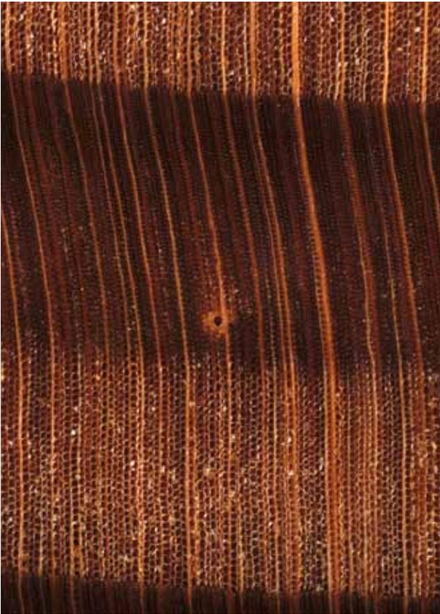
Abbildung 1: Makroskopische Aufnahme eines Querschnittes von Douglasienholz.
