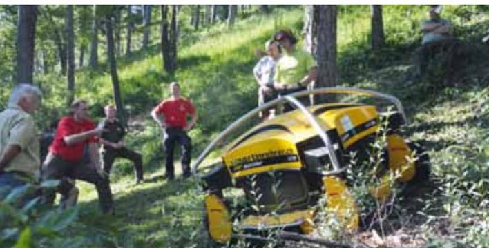
*Den versammelten Mitgliedern wurde der mit Traktionsseilwinde ausgestattete Hangmäher mit Sichelmesser vorgeführt.*
