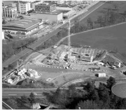
*Baustelle «Holzlogistik» HHKW Aubrugg AG. Links im Bild der Durchstich unter der Autobahn für die Transportförderbänder. Bildmitte, Abwurfbunker für die Hackschnitzel.*
