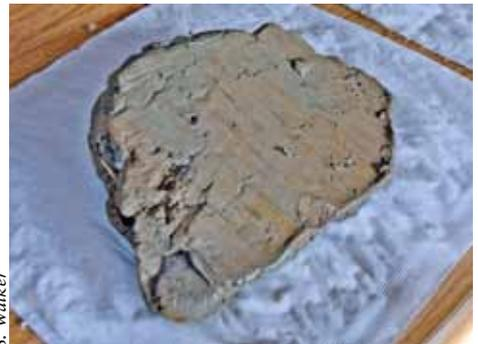
Abbildung 3: Bodenprobe mit Vernässungsmerkmalen.
